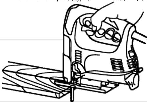
Рисунок 7. Положення виробу на початку розпили матеріалу.
