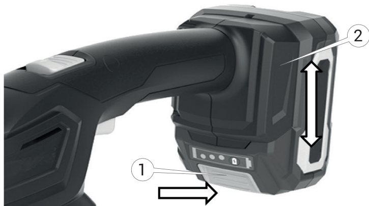
Рисунок 4. Схема встановлення чи зняття АКБ.
