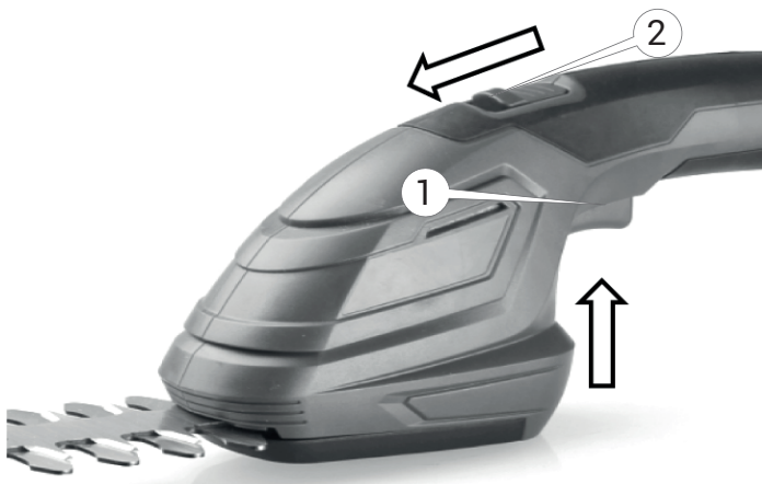
Рисунок 7. Схема увімкнення виробу.
