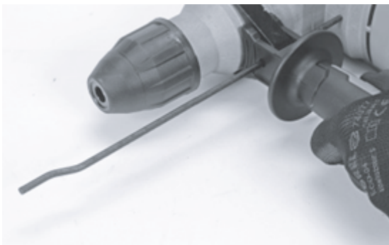
Рисунок 4. Встановлення обмежувача глибини свердління.
