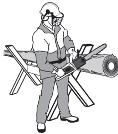
Рисунок 15. Схема розпилу колоди з використанням козлових опор.
