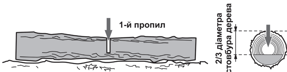
Рисунок 13. Схема попереднього розпи́лу колоди.
