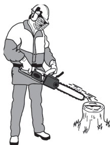
Рисунок 6. Схема перевірки системи подачі мастила.
