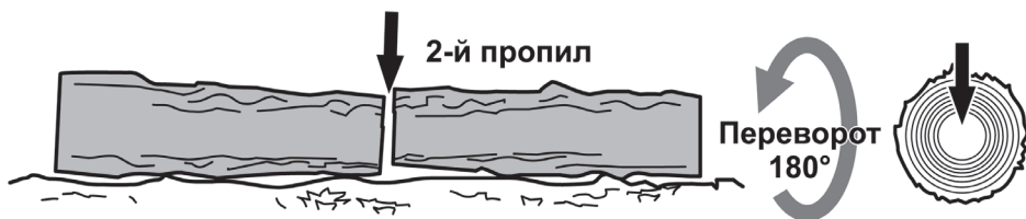
Рисунок 14. Схема остаточного розпи́лу колоди з протилежного боку.
