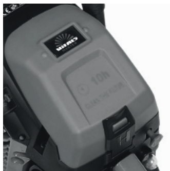
Рисунок 4. Схема розташування та фіксації відсіку повітряного фільтра.
