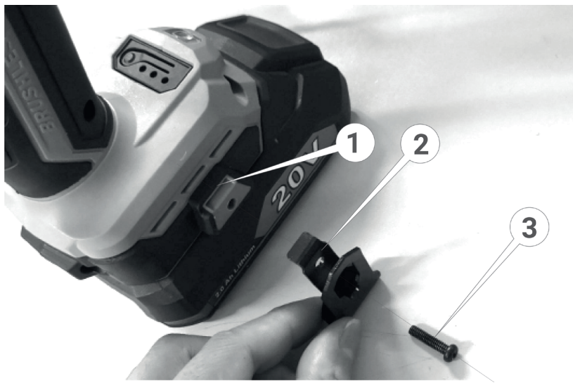
Рисунок 2. Схема встановлення кліпси кріплення.
