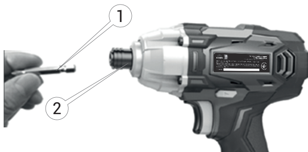
Рисунок 2. Схема встановлення / зняття біт
