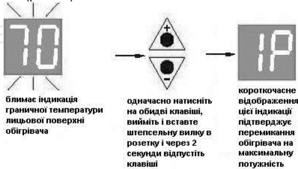
Рисунок 11. Послідовність дій при встановленні максимальної потужності
