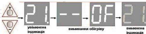
Рисунок 11. Послідовність зміни індикації після вимкненні терморегулятора
