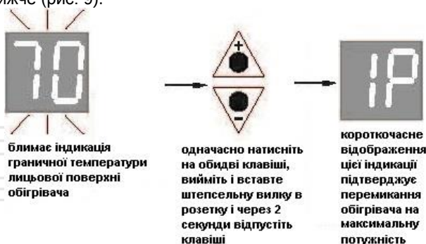
Рисунок 9. Послідовність дій при встановленні максимальної потужності
