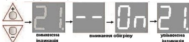
Рисунок 3. Послідовність зміни індикації при увімкненні терморегулятора
