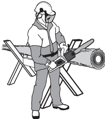
Рисунок 6. Схема розпилу колоди з використанням козлових опор.
