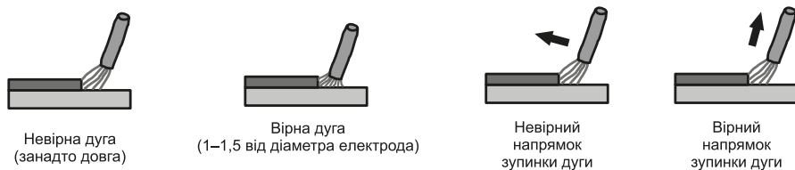
Рисунок 8. Варіанти розташування електрода із покриттям по відстані до деталі під час ручного дугового зварювання («ММА»).
