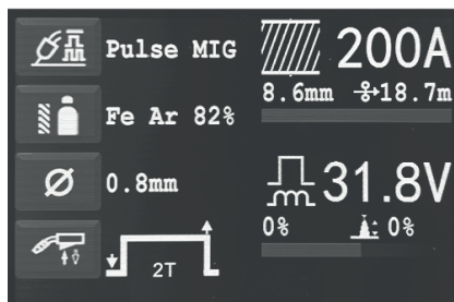
Рисунок 9. Приклад головного меню у режимі зварювання «MIG PULSE».
